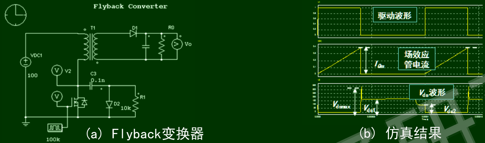
图 10 Flyback变换器的仿真结果
